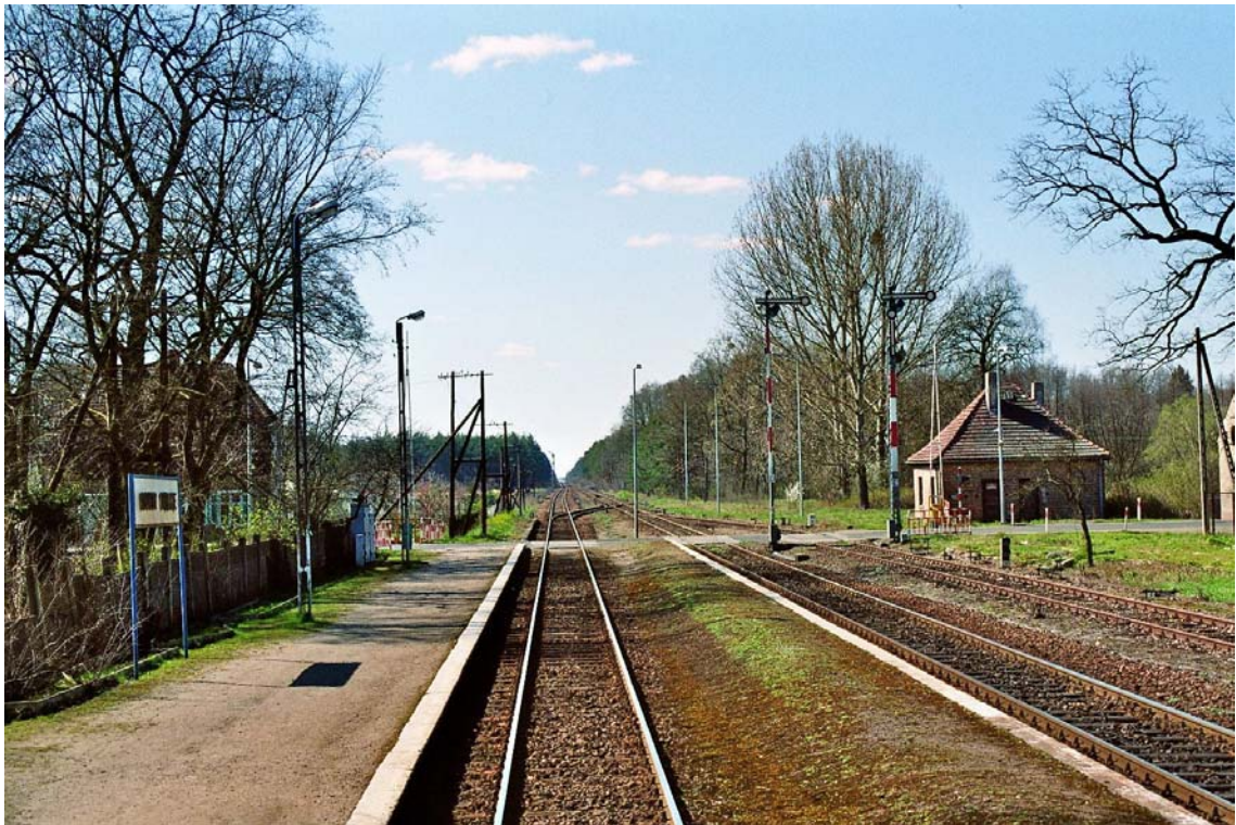
Abb. 21 Bf Nowiny Wielkie mit typischer Signalausstattung: Formhauptsignale, aufgestellt für Fahrstraßen. Fahrten auf dem falschen Gleis sind mit schriftlichen Befehl anzuordnen.
