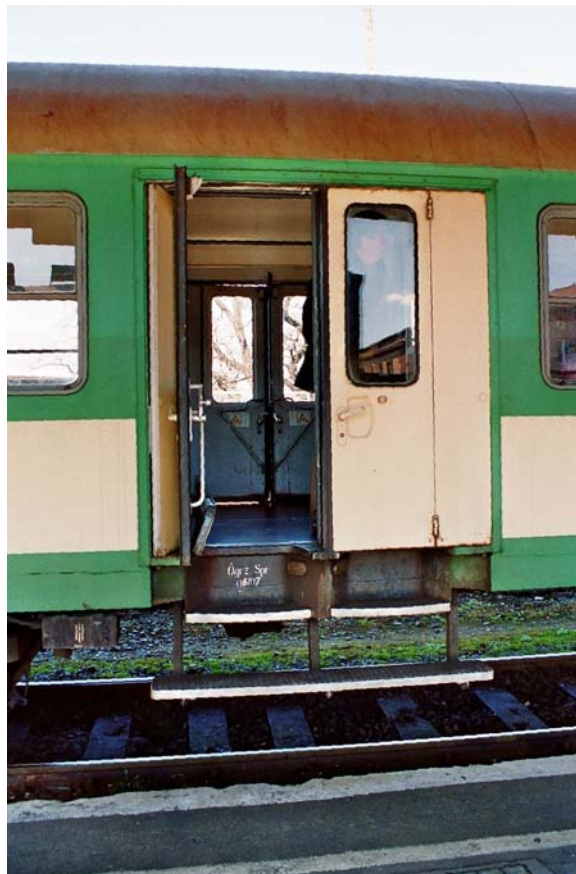
Abb. 14 Die Großraumwagen der Personen-züge sind Wagen der konventionellen Bauart mit mehrstufigen Tritten, ohne barrierefreie Gestaltung, Klimaanlage und Fahrgastinformationsanlage
